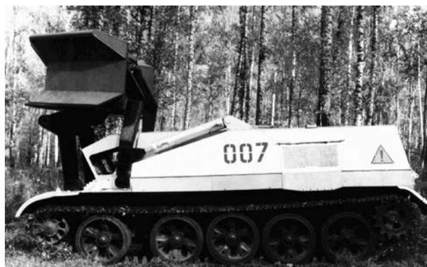
Изготовленный В. В. Мартыщенковым агрегат АЛТ-55 в транспортном положении
